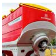
Встроенный вентилятор в бункере
