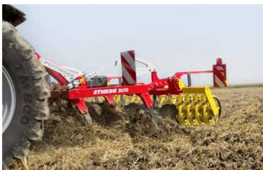
**Легкие двухбалочные культиваторы компактной конструкции лучше всего подходят для работы с тракторами с маленькой подъемной силой или небольшим собственным весом.**
