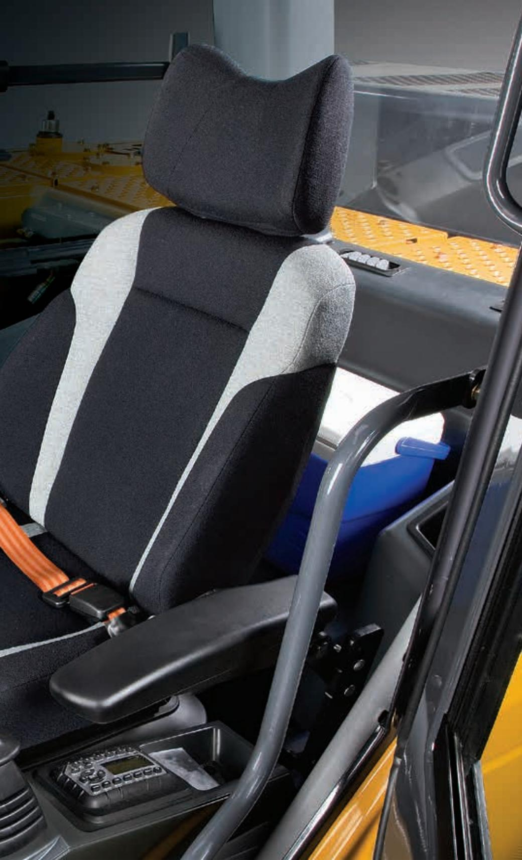
Уникальная герметичная кнопочная панель позволяет осуществлять запуск без ключа зажигания и обладает функцией противоугонной системы с возможностью ввода кодов безопасности.
